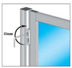
CHIUSURA: ruotare in senso orario LOCKING: turn clockwise
