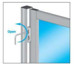
APERTURA: ruotare in senso antiorario OPENING: turn anticlockwise
